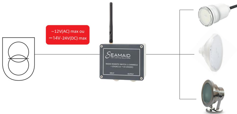
À N'UTILISER QU'AVEC UNE ALIMENTATION OU UN TRANSFORMATEUR ISOLANT DE SÉCURITÉ.
